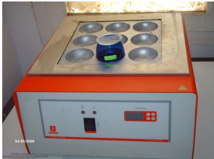
Figure N°15 : Plaque chauffante des verres de dégustation
