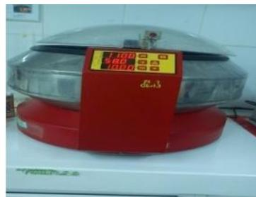
**Figure 1.** Butyromètre et centrifugeuse de séparation de matière grasse des produits analysés.
