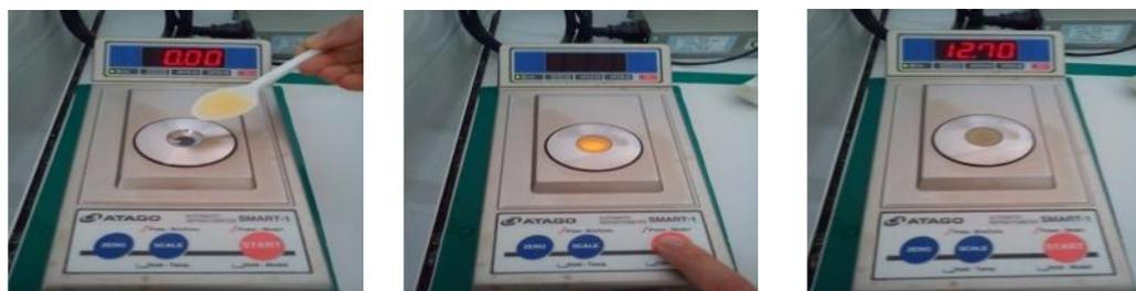
Figure 4. Étapes d'utilisation du réfractomètre.
