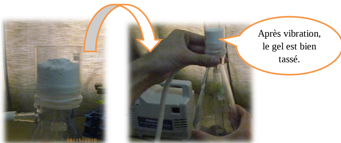
Figure 15 : Tassement de du gel.
