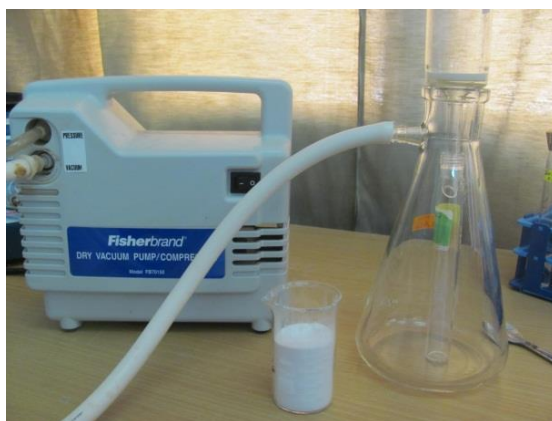
Figure 14 : Dispositif utilisé pour la chromatographie sous vide sur colonne sèche.
