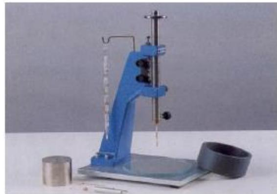
**Figure III.9 : Appareil de VICAT**
