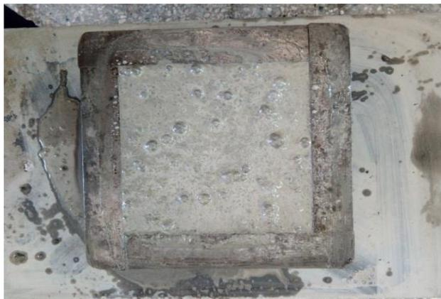
**Figure IV.1 : Bulles d'air dans le béton**
