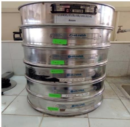
Figure III.3 : colonnes de tamis
