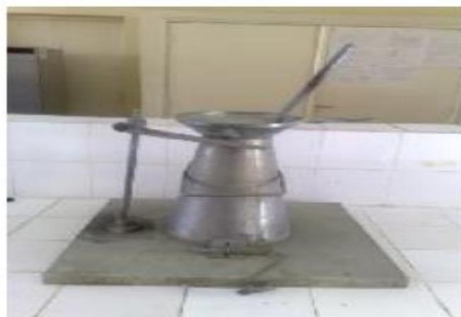
**Figure IV.3 : Cône d'ABRAMS**
