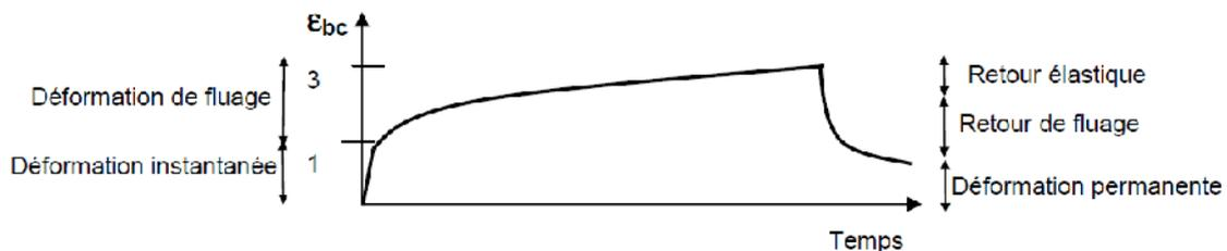
**Figure I.5 : Déformations instantanée et différée (due au fluage).**
