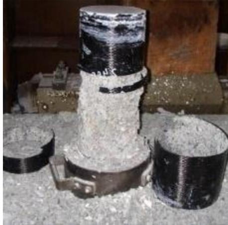
**Figure II.12.** Modes de rupture des colonnes confinées avec **CFRP** [37]
