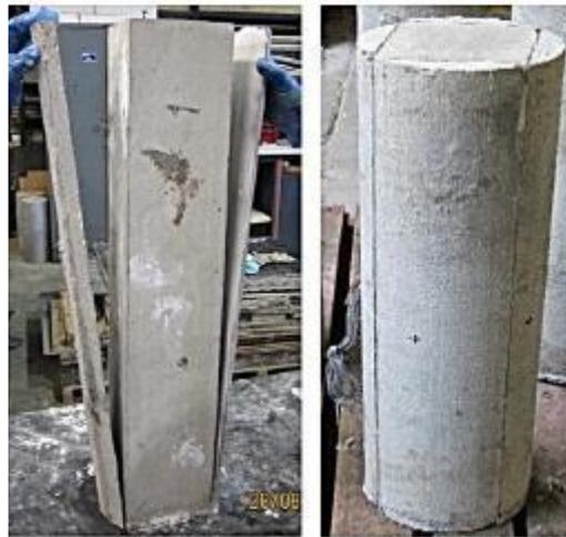
**Figure II.10.** Segments circulaires en béton [36]
