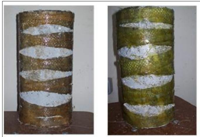
**Figure II.16.** Variation de la largeur de bande dans le confinement hélicoïdal [28]
