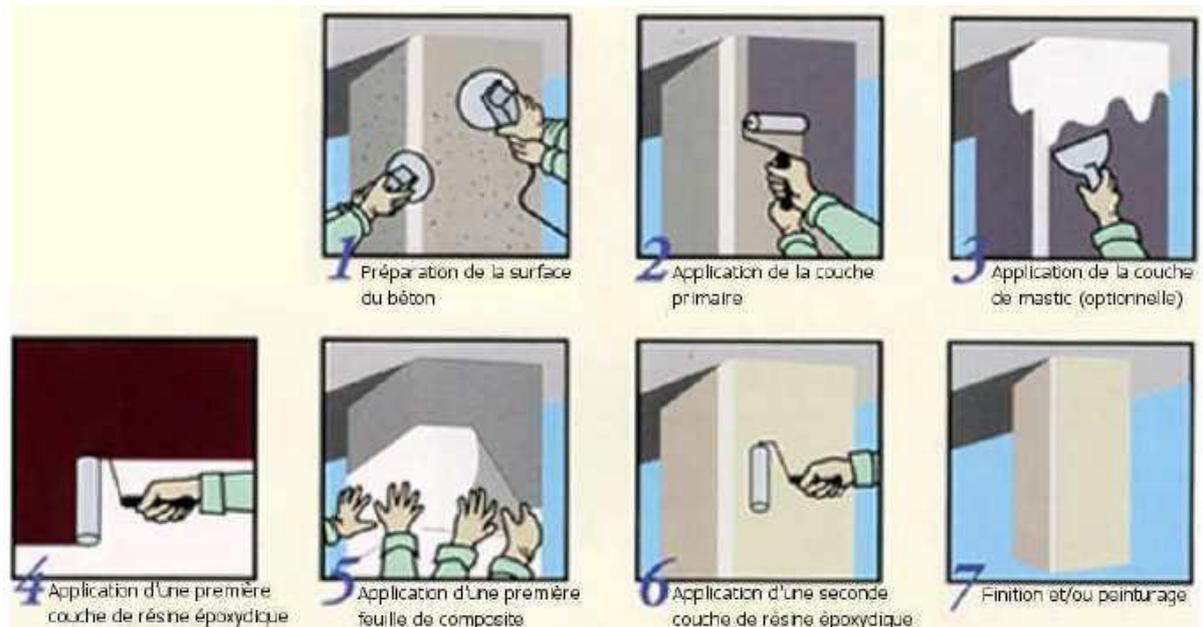
Figure II.1. Procédure de la mise en œuvre des plaques composites [24]
