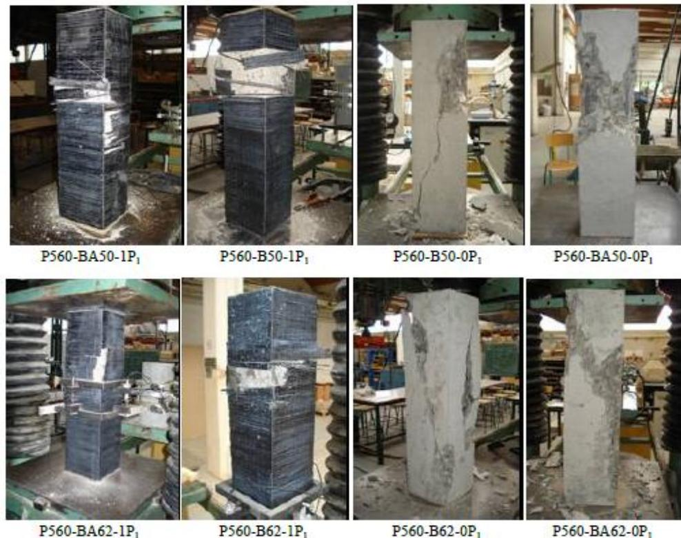
Figure II.14. Effet de l'élancement sur les colonnes confinées avec CFRP [17]
