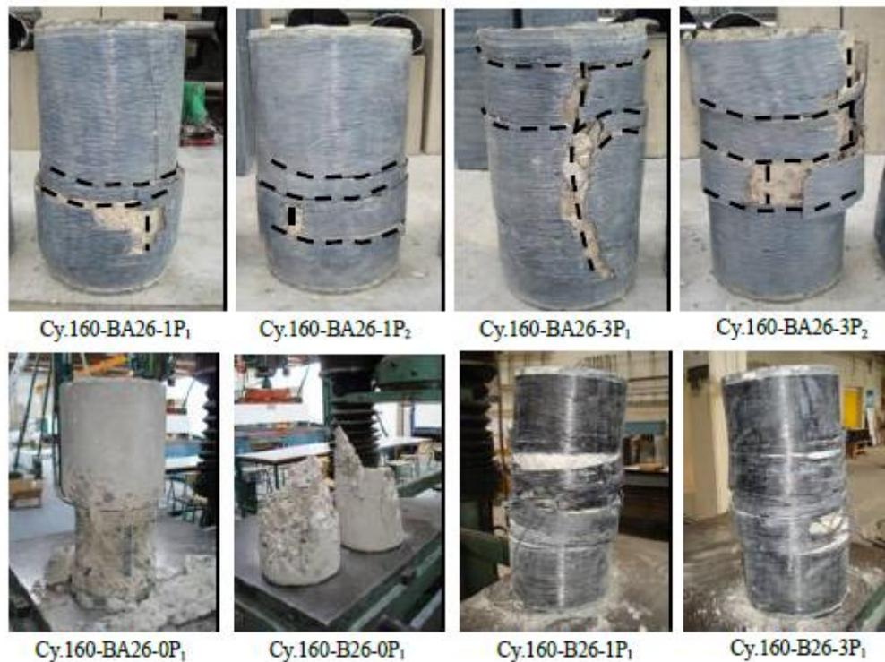
Figure II.13. Effet de la géométrie des colonnes confinées avec CFRP [17]
