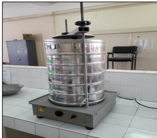
**Figure III.10 :** Machine à tamiser
