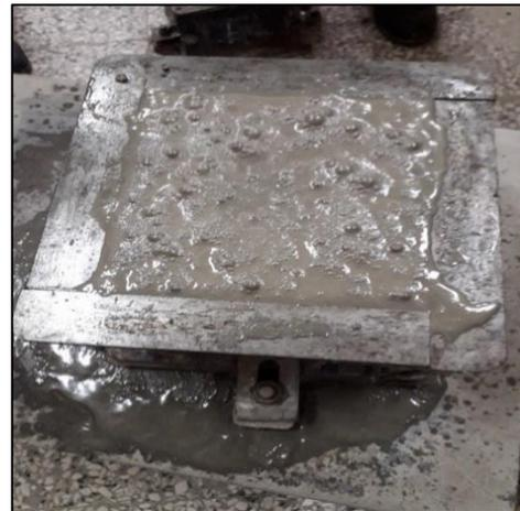
**Figure IV.3 :** Apparition de bulles d'air
