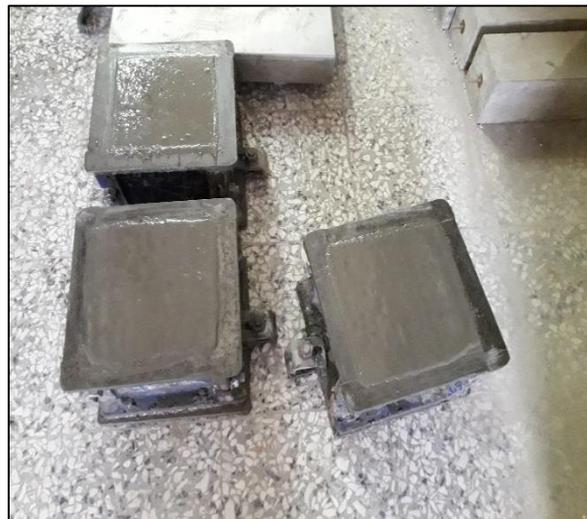
**Figure IV.4 :** Remplissage des moules.
