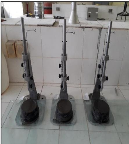
Figure III.15 : Appareil de Vicat
