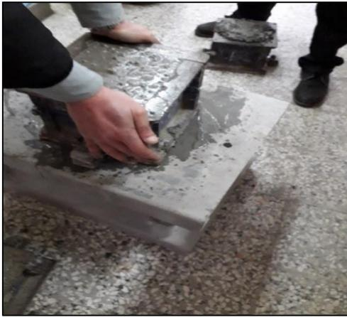
**Figure IV.2 :** Vibration du béton.
