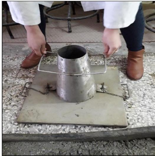
Figure IV.6 : Cône d'Abrahms.
