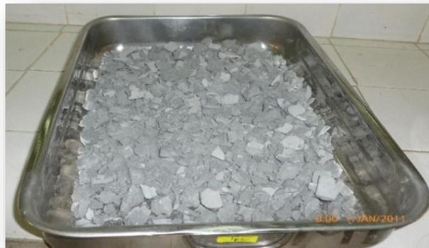
Figure 2.14 échantillon après concassage
