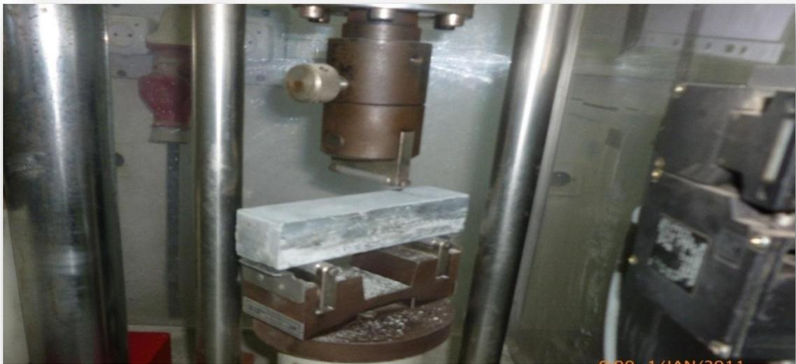
Figure 2.8 Essai de rupture par flexion
