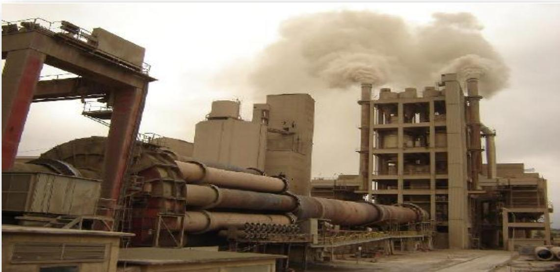
Figure 1.27 Four rotatif (Phase cuisson)
