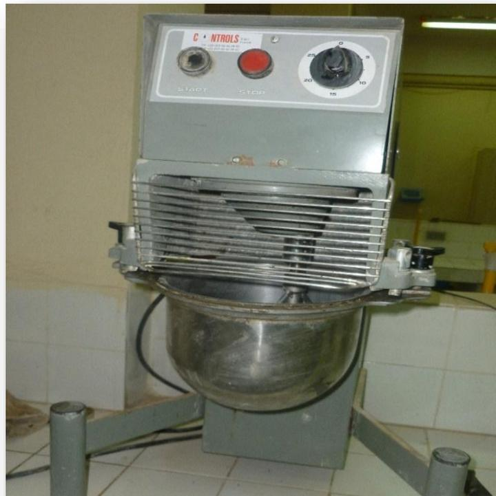
Figure 2.5 Malaxeur à mortiers utilisé pour la fabrication des monolithes
