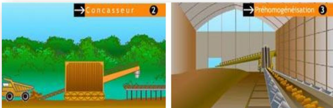
Figure 1.3 Concassage et pré-homogénéisation
