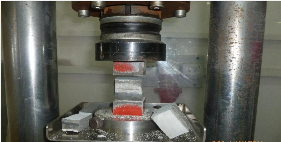
Figure 2.11 Rupture par compression
