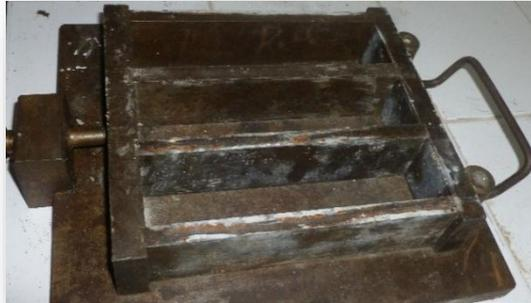
Figure 2.6 Les moules utilisés dans la préparation des monolithes
