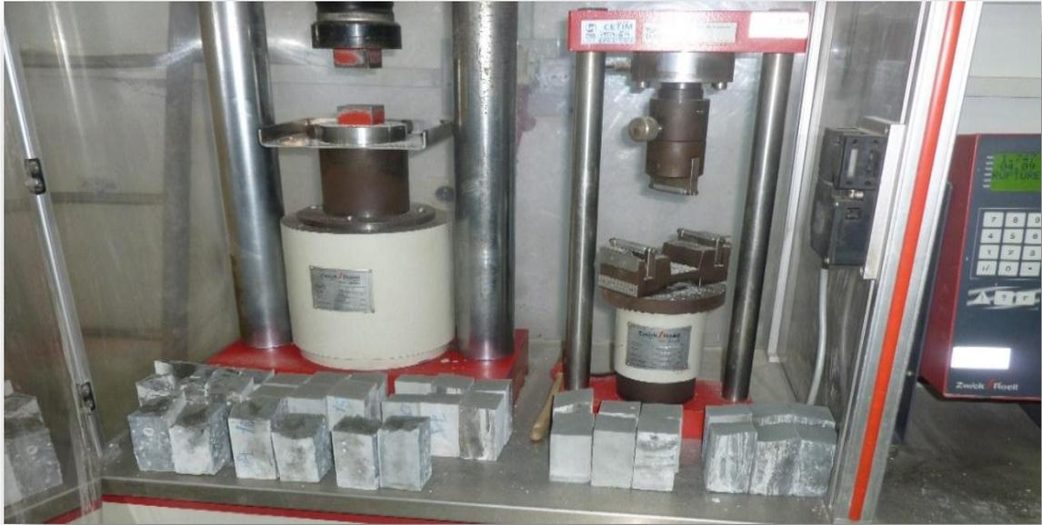
Figure 2.12 Presse hydraulique de type control pour l'écrasement des éprouvettes
