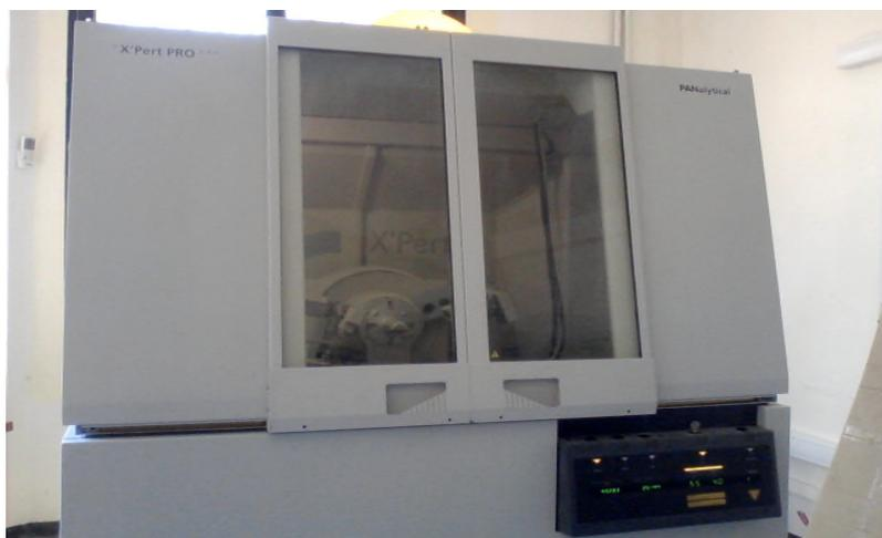
**Figure II-12:** Diffraction des Rayons X (DRX).
