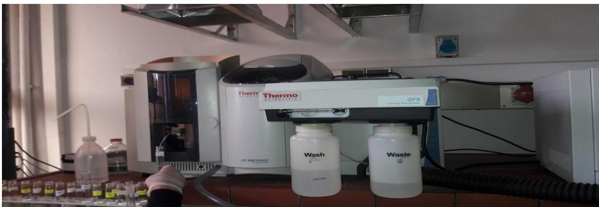
Figure 26: le dosage au Spectrophotomètre d'absorption atomique (génie des procédés Université de Bejaia, 2018)
