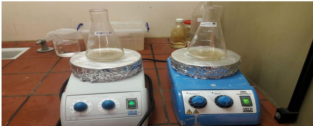
**Figure 23: Evaporation des mélanges sur plaque électrique (Originale, 2018).**
