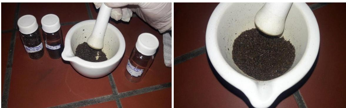
**Figure 19: Broyage des échantillons après séchage à l'étuve (Originales, 2018)**
