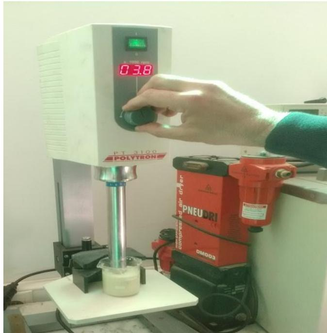
**Figure 20 :** Homogénéisation par ultra-turax des deux phases huileuse et aqueuse de la pommade anti-inflammatoire.
