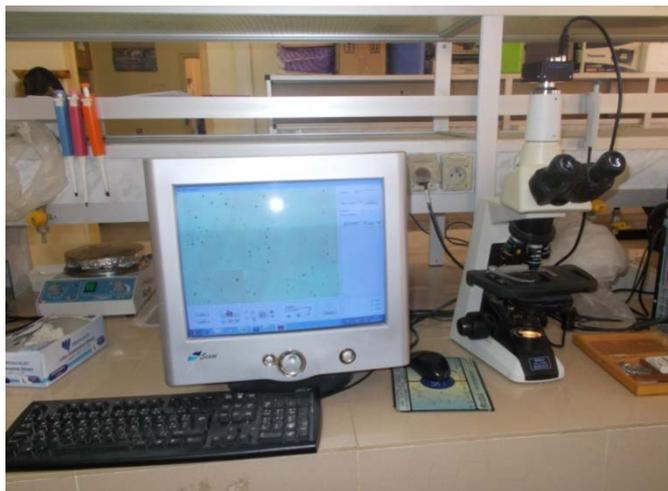
**Figure 15** : Microscope optique couplé à un logiciel Optika micro image Analysis
