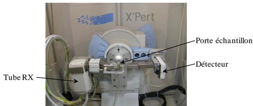
**Figure14** : Diffractomètre (X'pert pro Pana lytical)
