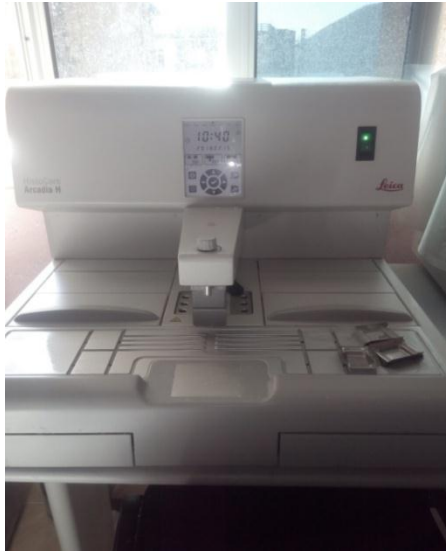
Figure06 : Appareil à inclusion Figure 07 : Cassette en plastique.
