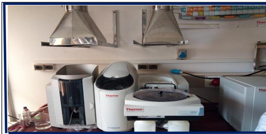
Figure 9 : Spectrophotomètre d'absorption atomique.
