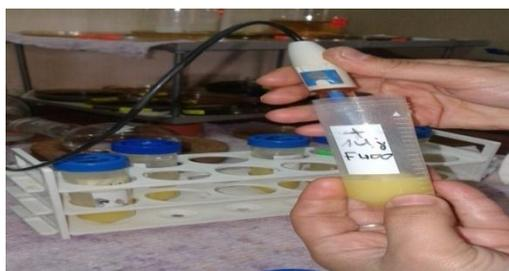
Figure 05 : Mesure du pH
