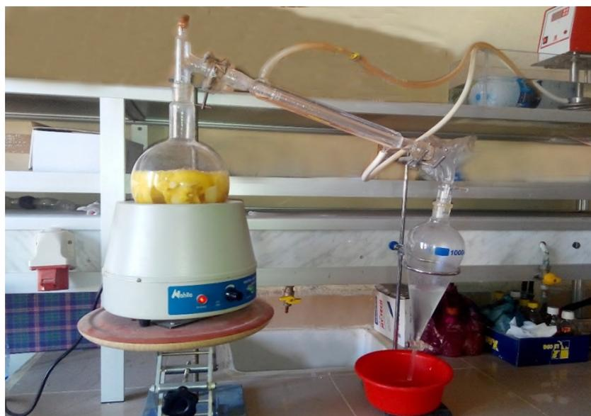
**Figure 3 :** Montage d'hydrodistillation de type Clevenger modifié.
