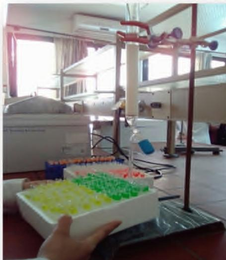
**Figure 5:** Photographie originale de la chromatographie sur colonne
