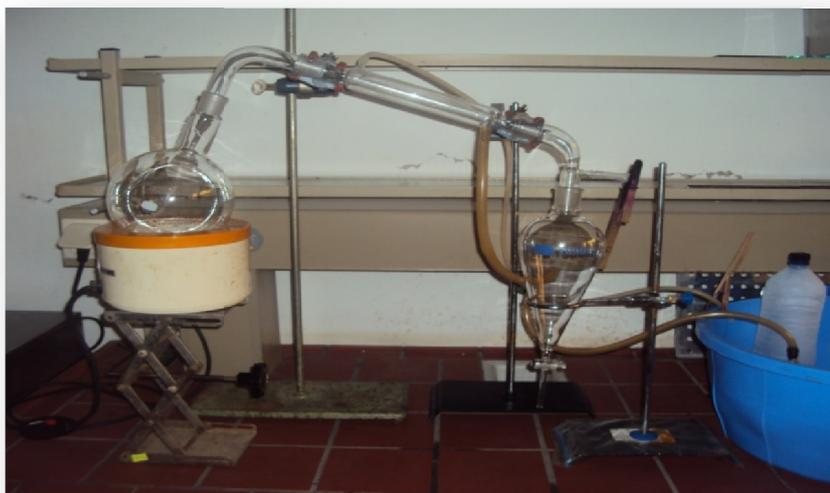
**Figure 05** : Montage d'hydrodistillation de type Clevenger.
