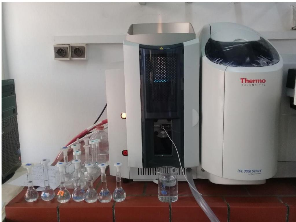
**Figure 04-** Spectromètre d'absorption atomique à flammes utilisé dans notre travail.
