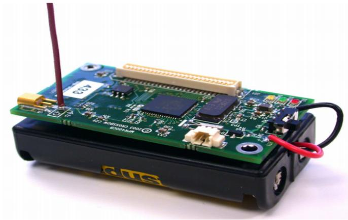
FIGURE 1.1 – Nœud capteur Mica [2]
