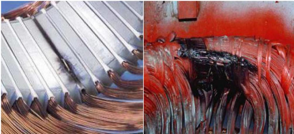
*Figure (2.1)* Exemples de dégâts dus au défaut de court-circuit statorique d'un moteur asynchrone [8].
