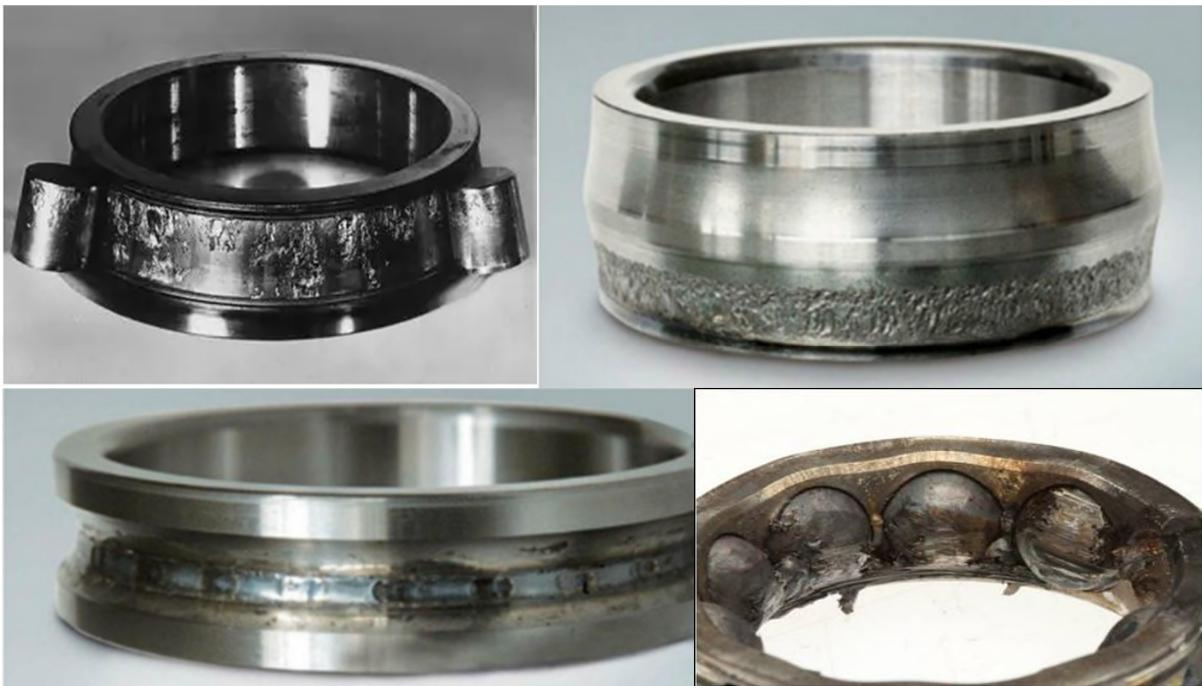
Figure (2.4) : Quelques défaillances affectant les roulements [11]
