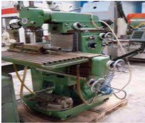
**Figure I.10:** Une fraiseuse
