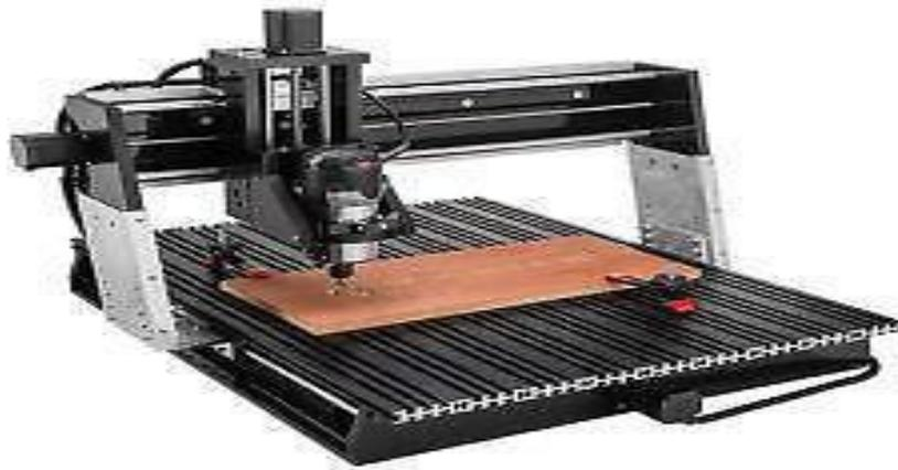
Figure I.2: un modèle récent d'une MOCN
