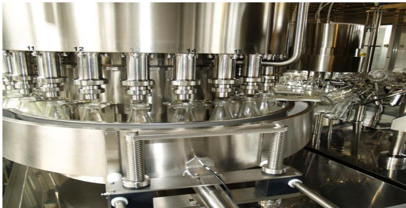
**Figure I.4 :** Remplisseuse rotative
