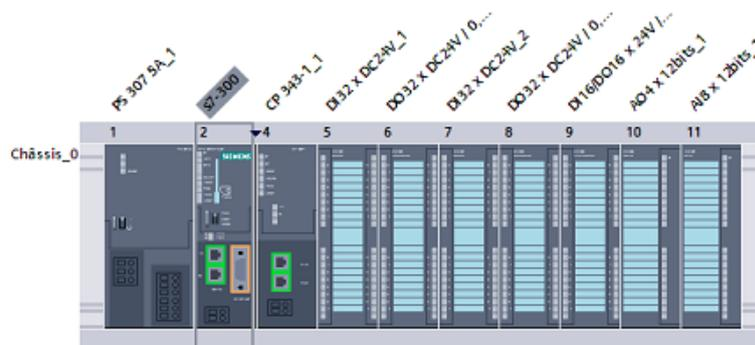
**Figure III.21 :** Constitution de l'API s7-300 de notre installation
