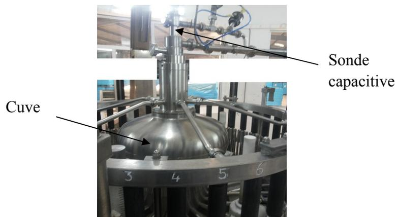
Figure III.28 : Ensemble cuve et sonde capacitive
