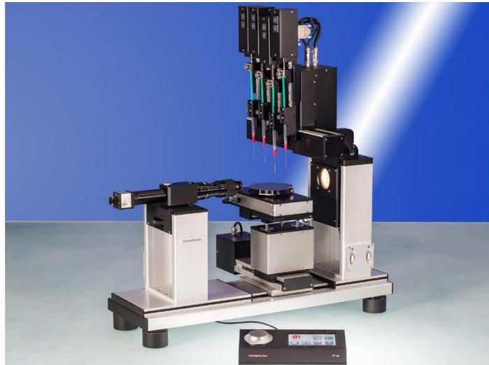
**Fig. IV. 6:** système de dosage piloter
