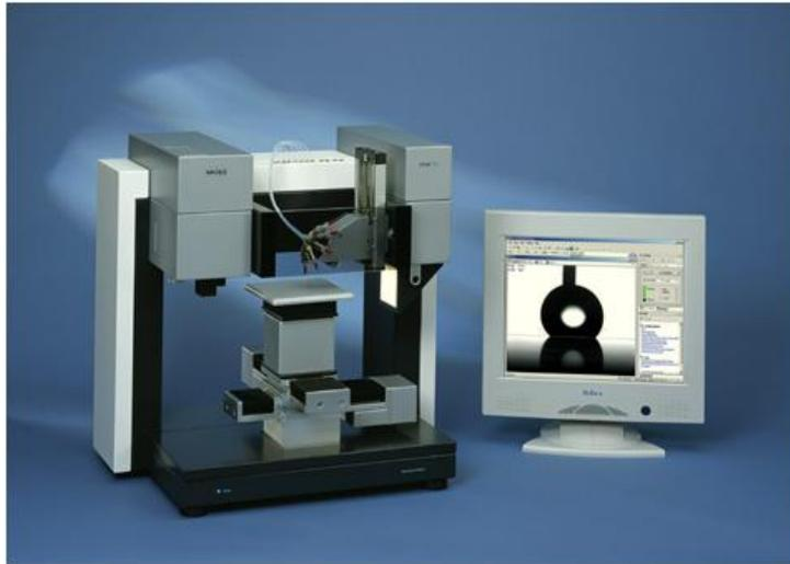
**Fig. IV. 5 :** Analyseur de la forme de la goutte
