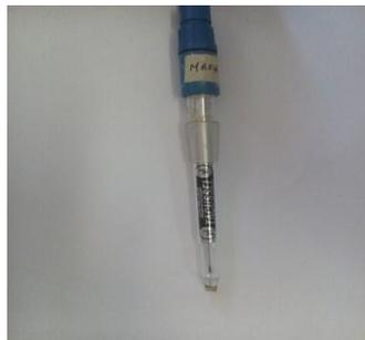
**Figure II.5.** Electrode auxiliaire
