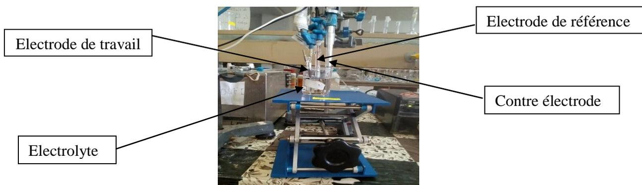
**Figure II.2.** Montage de la Cellule électrochimique.
