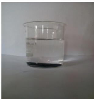
**Figure II.7.** plaque de cuivre immergé dans 0.5M NaOH.
