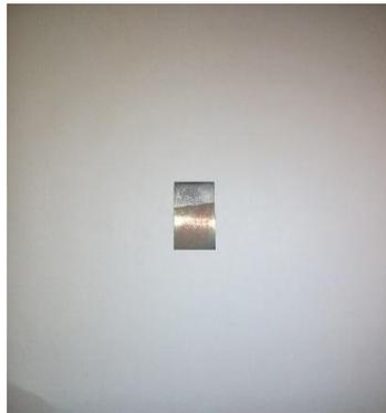
**Figure III.3.** Photo du dépôt de de l'oxyde de cuivre  $\text{Cu}_2\text{O}$  dans  $[\text{CH}_3\text{COONa}]=0.2\text{M}$ ,  $[(\text{CH}_3\text{COO})_2\text{Cu}]=0.01\text{M}$  à  $t_{\text{depot}}=7\text{min}$ ,  $\text{pH}=6$ ,  $T=55^\circ\text{C}$  et  $E= -0.1\text{V/ECS}$  sur une électrode en acier.
