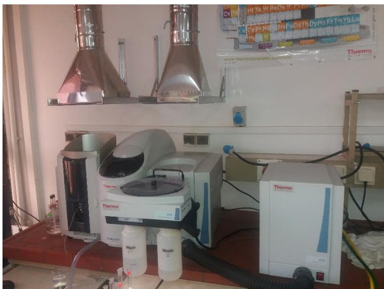
Figure IV.2 : spectrophotomètre d'absorption atomique Thermo scientific de type ICE 3500
