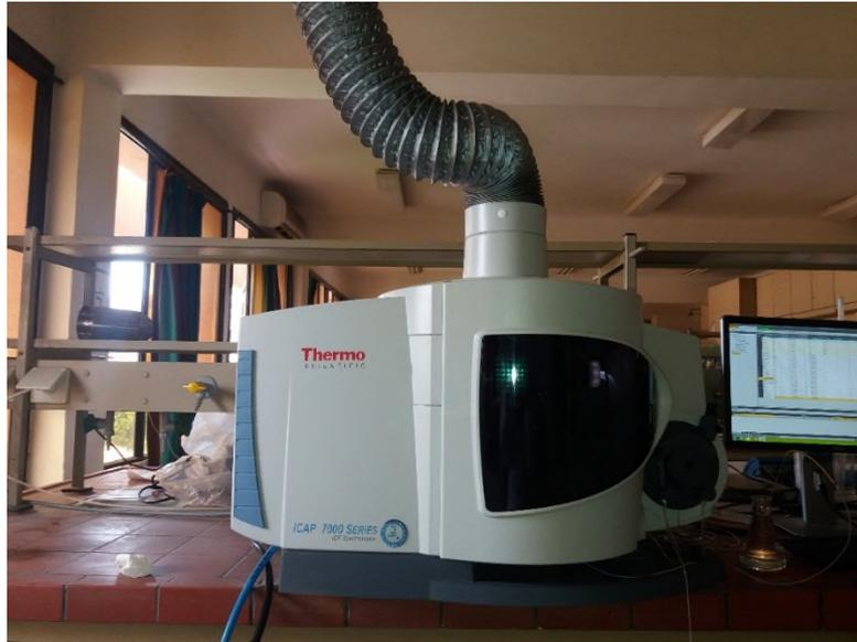
**Figure IV.3 :** ICP-AES de paillasse Thermo scientific de type ICE 3500
