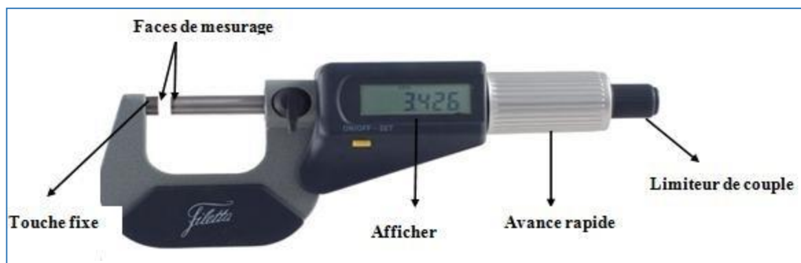
Figure IV.14 : photo du micromètre Schut
