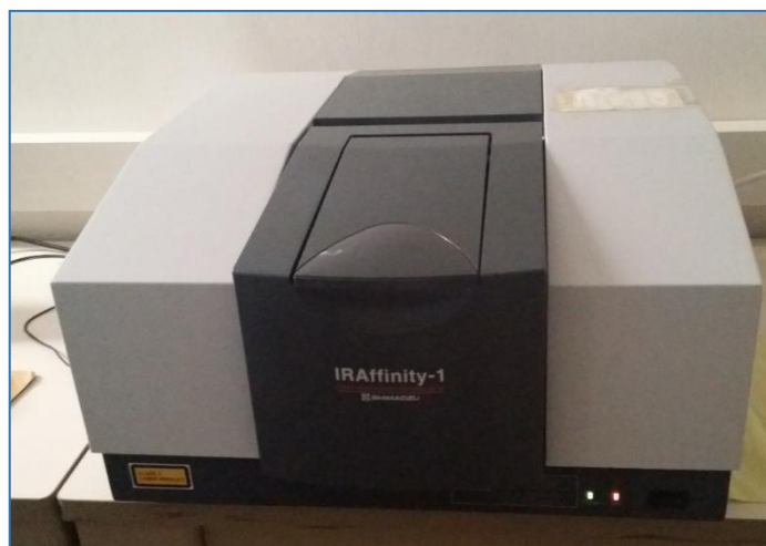
Figure III.7 : Spectromètre à transformée de Fourier de marque Affinity-1 SHIMADZU
