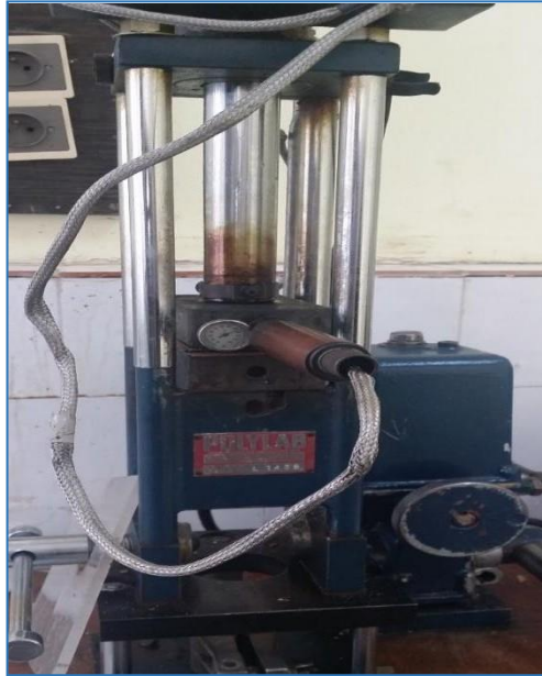
Figure III.3: une presse manuelle de marque POLYLAB
