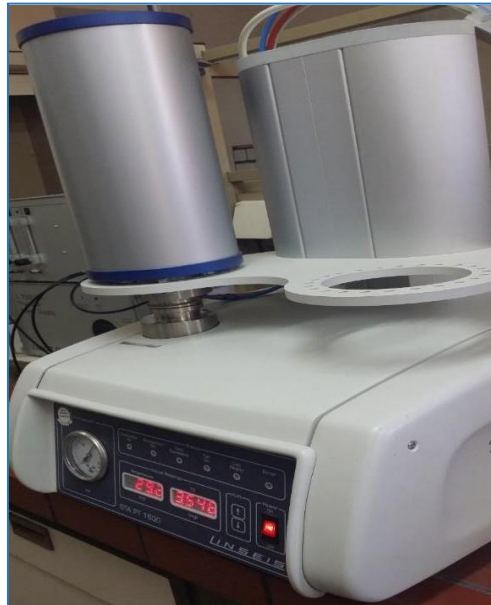
Figure III.13 : la thermogravimétrie LINSEIS STA PT 1600
