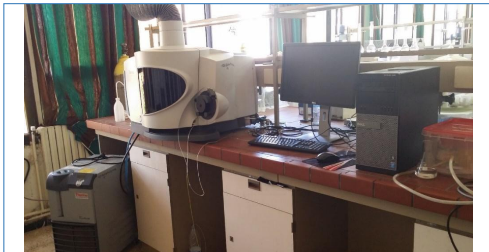
Figure III.12 : Appareil Spectromètre ICP de marque Thermo SCIENTIC
