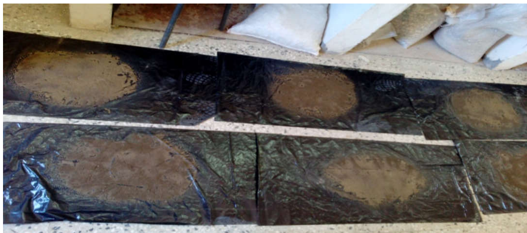
Figure II.14 Sol après solidification/stabilisation
