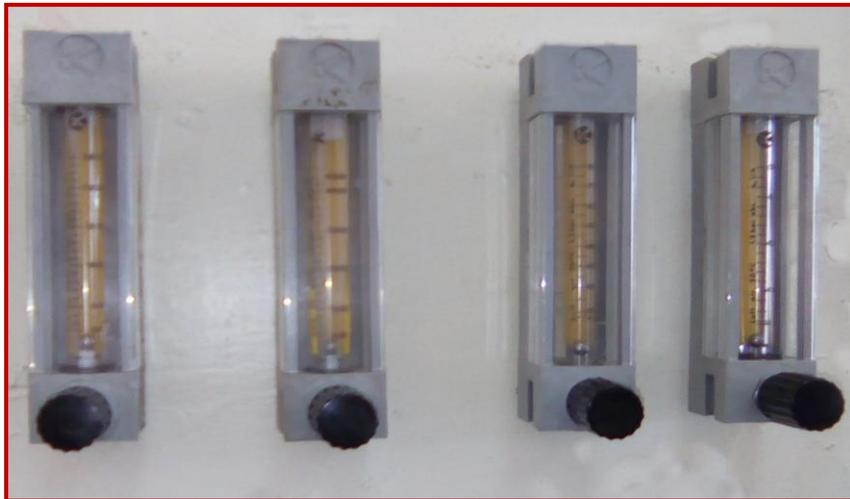
**Figure III.9 :** Débitmètres à air placés en parallèle
