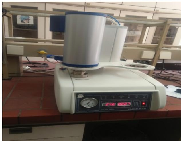
**Figure 20 :** L'appareil d'analyse ATG/DTG.
