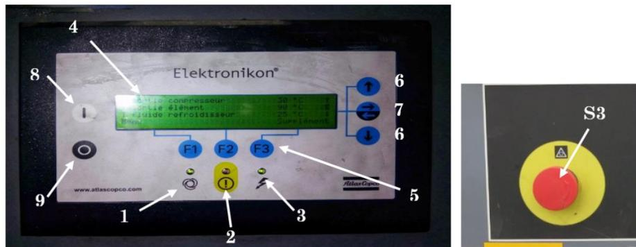
Figure II.9 Système de contrôle [14]
