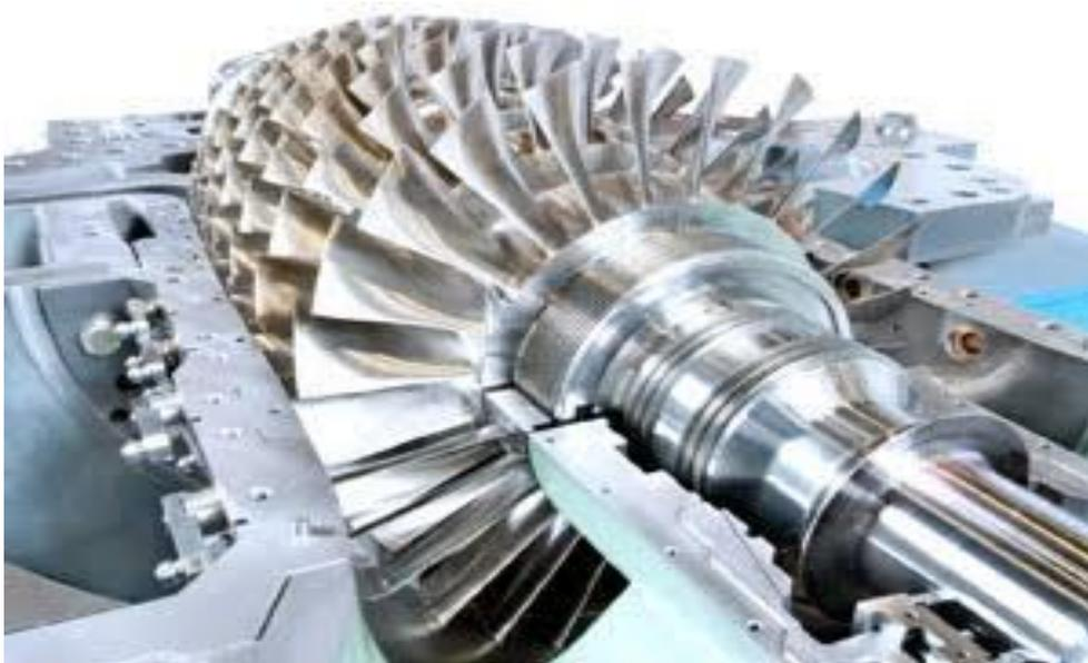
Figure I.4 Compresseur axial
