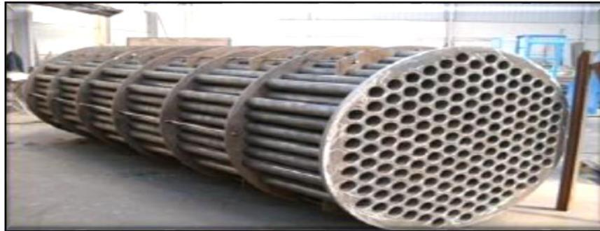
**Figure I.12 :** faisceau tubulaire
