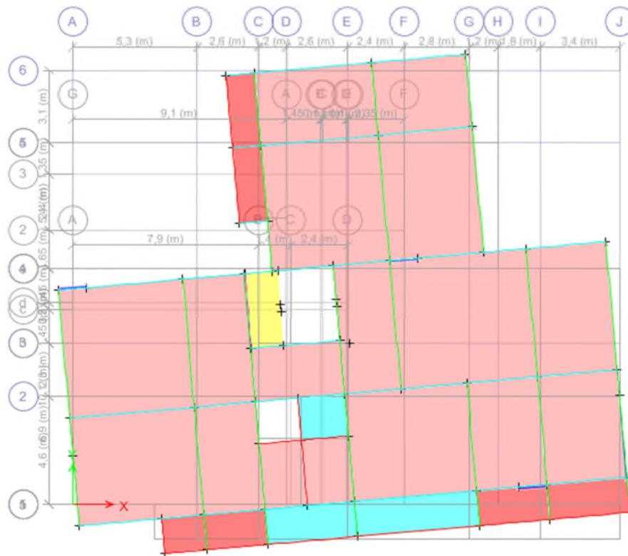
Figure III.6. Mode 3 (Rotation suivant l'axe Z-Z)
