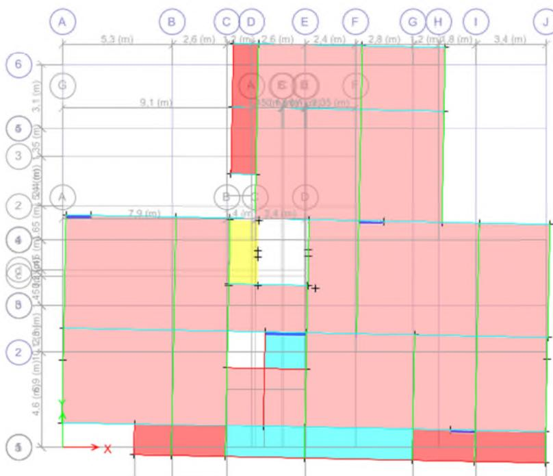
Figure III.5.Mode 2 (Translation suivant l'axe Y-Y)
