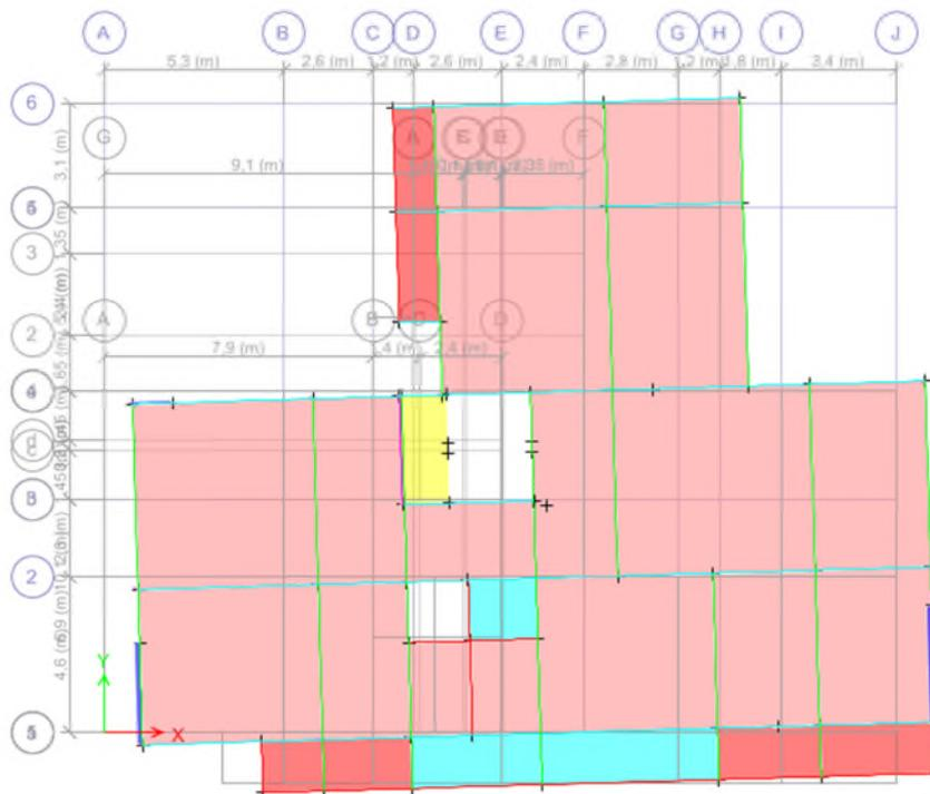
Figure III.4.Mode 1 (Translation suivant l'axe X-X)
