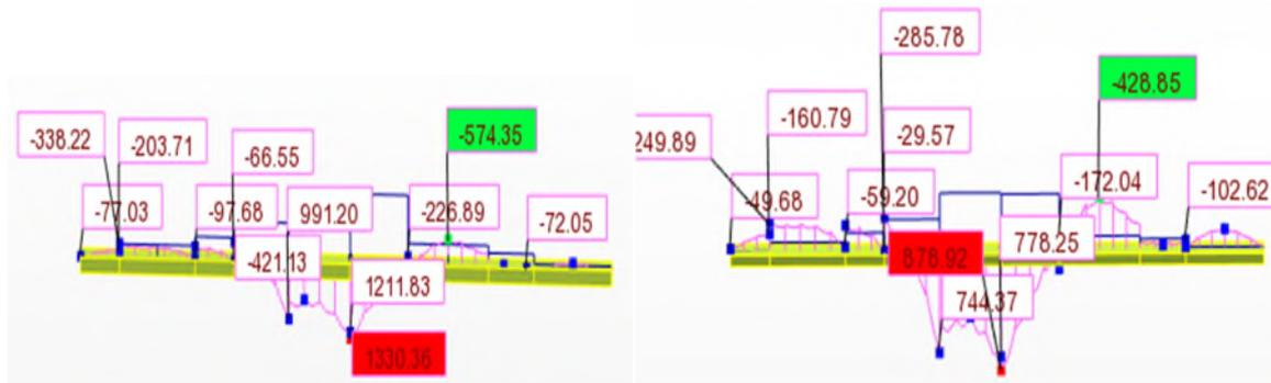
Figure V.10. diagramme monument fléchissant à ELU et ELS sur les nervures du sens x-x
