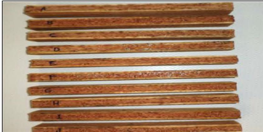
**Figure II.24** : Représentation photographique des panneaux sandwiches finis. [7]
