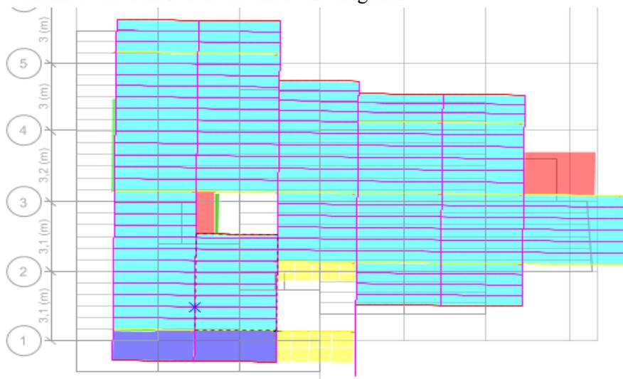
**Figure III.4.** Mode 1 de déformation (translation suivant l'axe diagonal avec X prépondérant).
