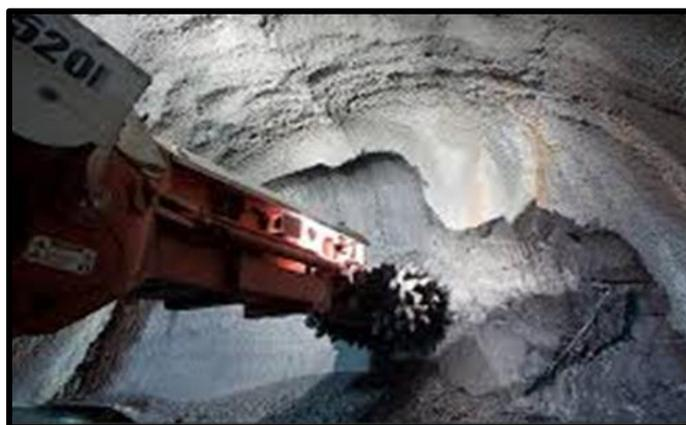
**Figure I.7 :** Machine à attaque ponctuelle.
