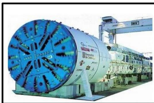
**Figure I.8 :** tunnelier à bouclier.
