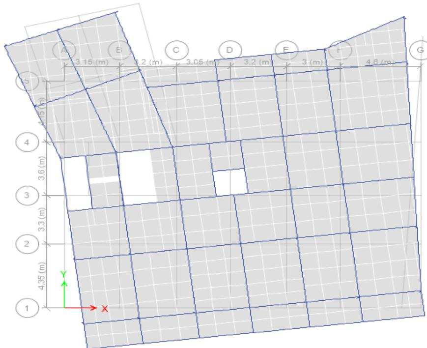
Figure IV.6. 3<sup>ème</sup> mode de vibration (Torsion autour de l'axe Z-Z).
