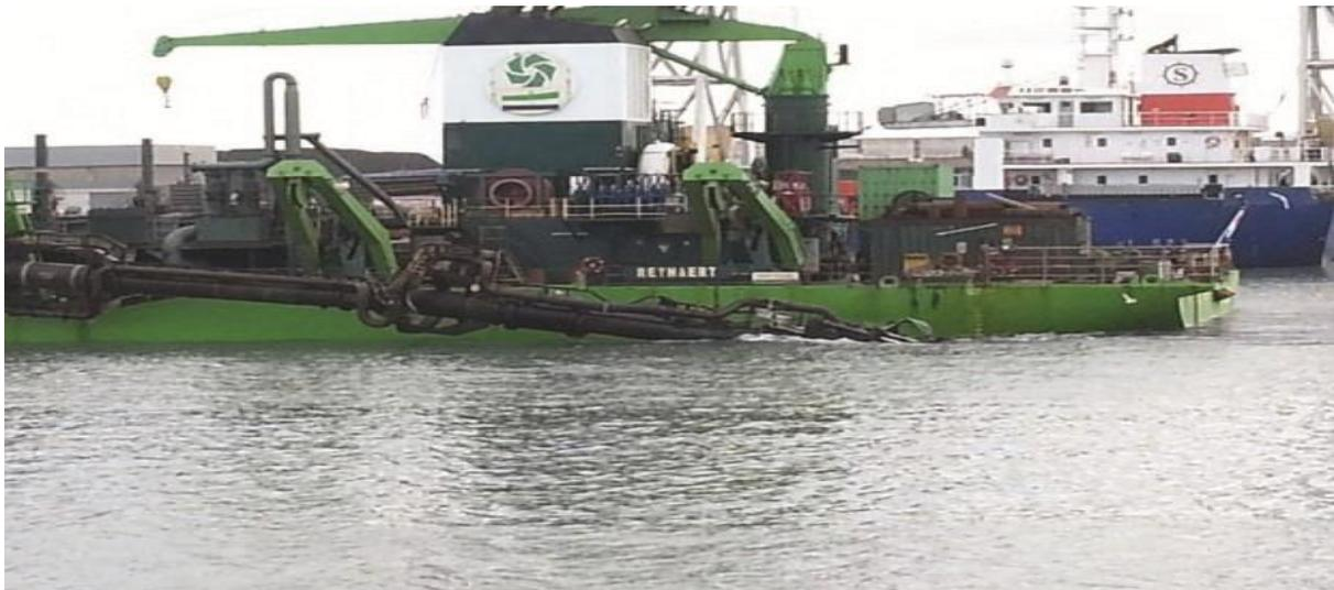
**Figure II.2.1 :** La drague Reynaert, un navire spécialisé dans le curage des ports dans le port commercial de Annaba.
