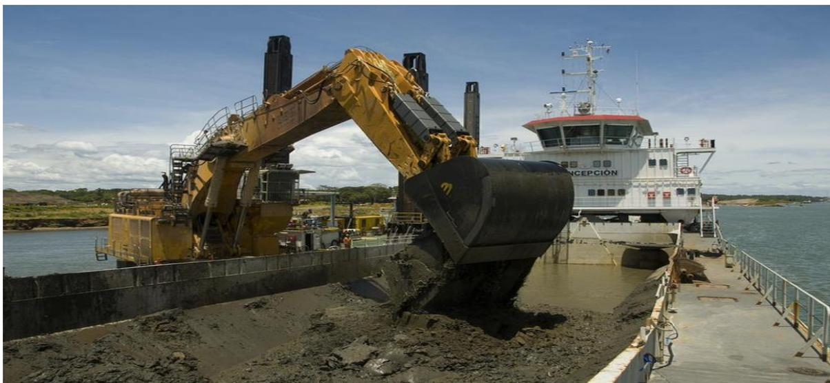
**Figure III.7 : La drague à pelle rétro-caveuse à benne preneuse.**
