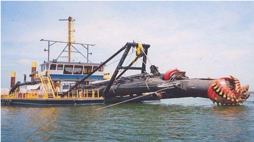
**Figure III.6 : Navire spécial drague suceuse a désagrégateur.**
