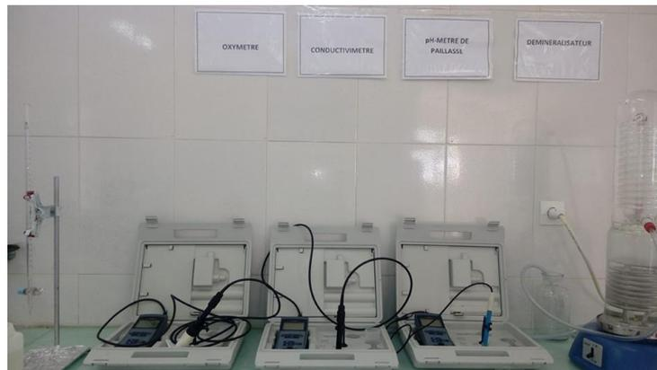
**Figure II.3 :** Equipements portatifs de mesure de paramètres physico-chimiques.
