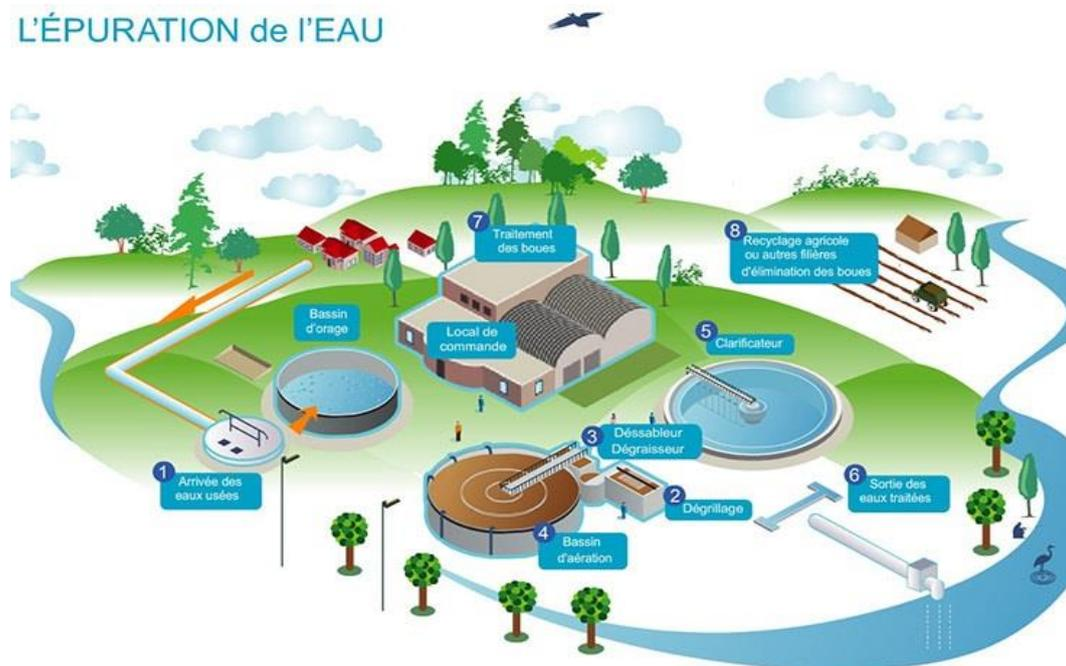
**Figure I.1** : Schéma des différentes étapes d'épuration des eaux résiduaires. (**Site internet 3**)
