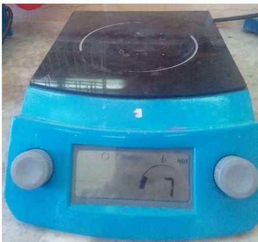
Figure II. 3. Agitateur magnétique.
