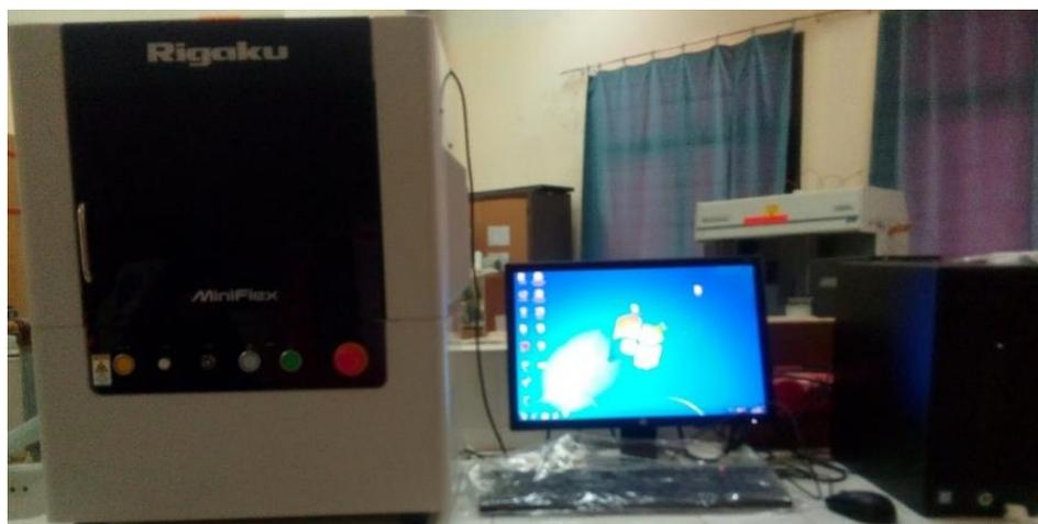
Figure II.9 : Diffractomètre à rayons X.
