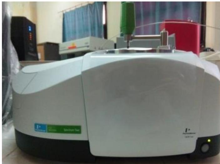
Figure II.8 : Spectrophotomètre IR.
