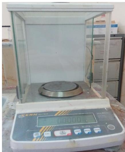
Figure II. 5 : Balance analytique.
