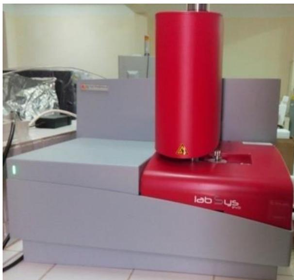
Figure II.10 : Analyseur thermogravimétrique (ATG).
