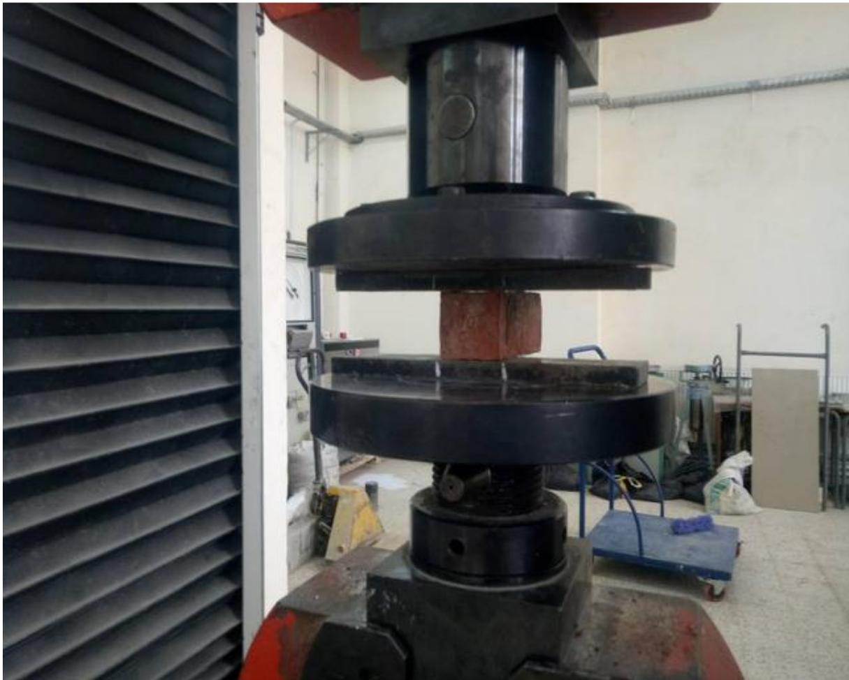
**Figure3 9:** Appareil de la résistance à la compression (laboratoire génie civil université Tizi Ouzou). [44]
