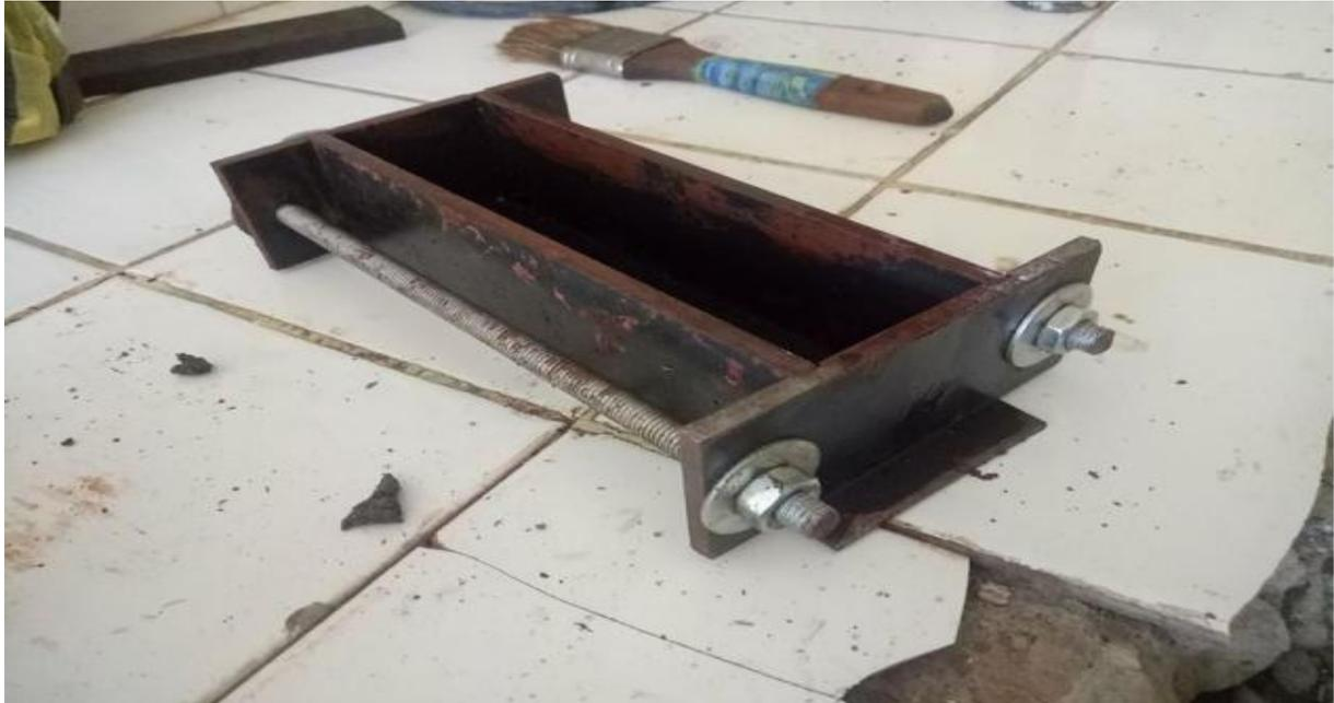
**Figure3 6:** Le moule 4\*4\*16 (laboratoire génie mécanique université Bejaia). [44]
