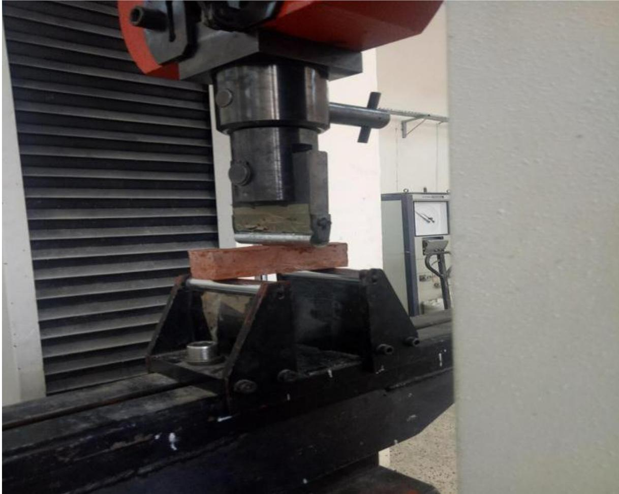
**Figure3 8:** Appareil de la résistance à la flexion (laboratoire génie civil université Tizi Ouzou). [44]
