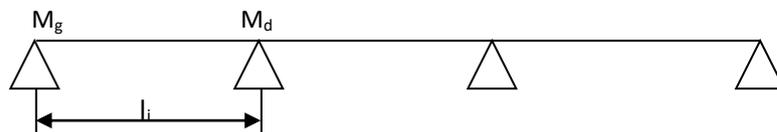
**Figure III.4.** Schéma statique de la poutrelle.
