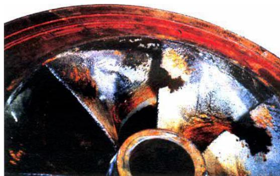
**Figure (V.9):** Érosion par cavitation d'une roue de pompe centrifuge
