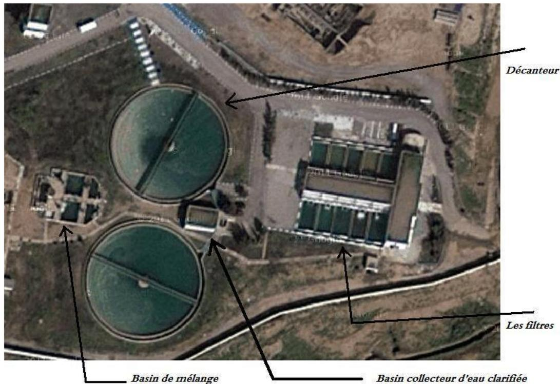
**Figure IV.3 : Ouvrages de décantation, filtration, mélange et collecteur**
