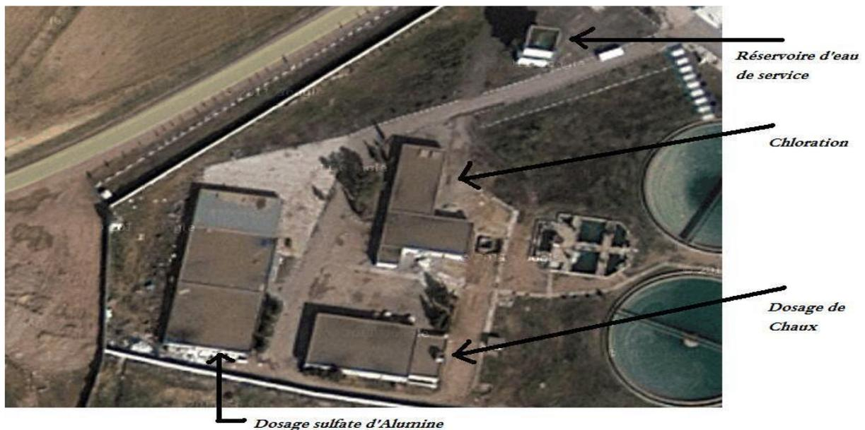
*Figure IV.2 : Les bâtiments des réactifs*
