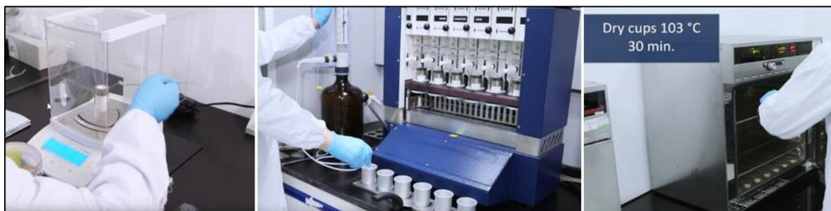
Figure IV.13 - Les étapes de réalisation des attaques NFD-ADF à l'aide l'appareil *Fibertec system M-Hot extractor (FOSS)* pour la détermination de la teneur en fibres.
