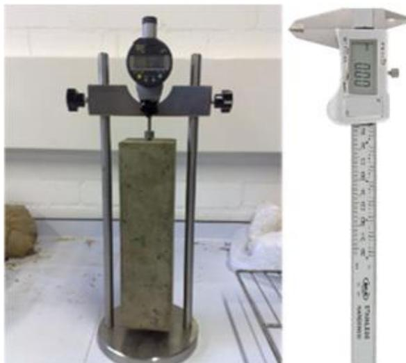
Figure IV.24 - déformomètre (à gauche), pied à coulisse (à droite).
