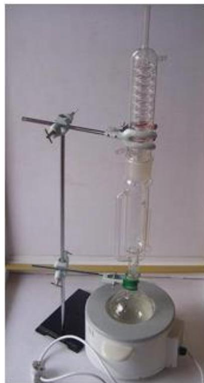
Figure IV.16 - Schéma et principe de fonctionnement de l'appareil de Soxhlet.
