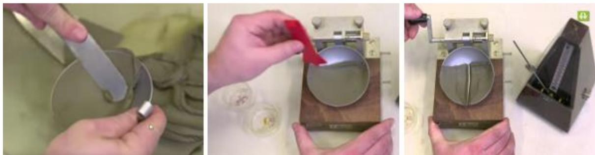
Figure IV.18 - Les étapes de détermination de la limite de liquidité (WL) selon la norme NF P94-051.
