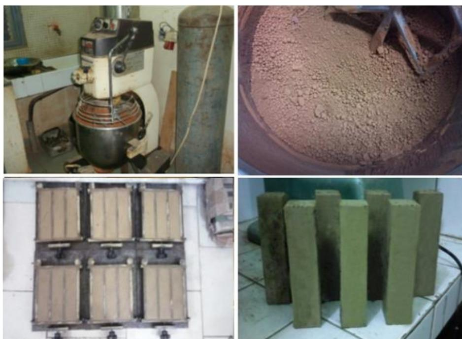
Figure IV.3 - Images des étapes de confection des éprouvettes expérimentales[60], [78].
