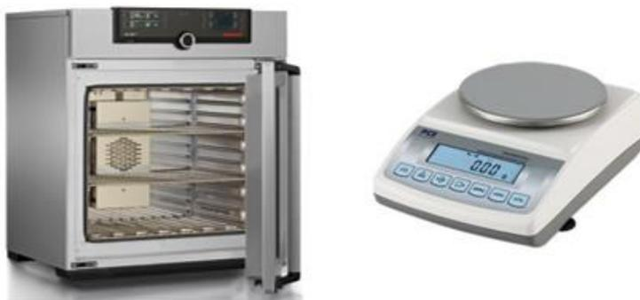
Figure IV.10 - Matériel nécessaire pour déterminer la masse sèche et la teneur en eau : une étuve (à gauche) et une balance de précision de laboratoire (à droite).
