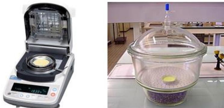
Figure IV.11 - Image de dessiccateurs halogène (à gauche) en verre (à droite).
