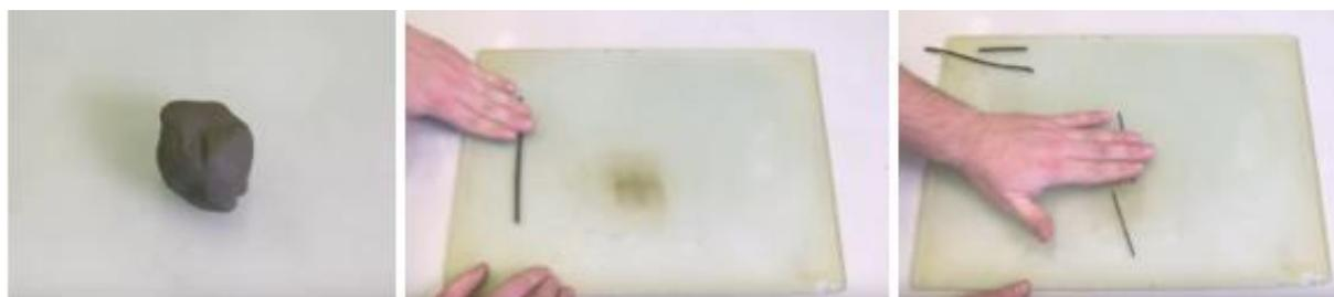
Figure IV.19 - Les étapes de détermination de la limite (WP) selon la norme NF P94-051.
