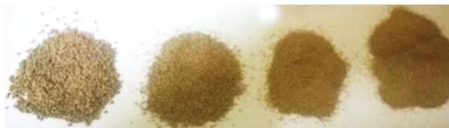
Figure IV.2 - Les différents diamètres des noyaux de dattes après broyage
