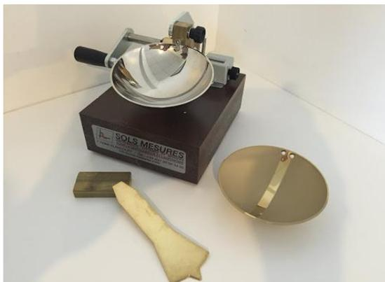
Figure IV.17 – Image s'appareil de Casagrande
