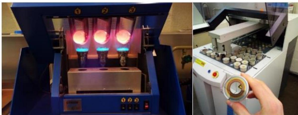
Figure IV.5 - Coulage de la pastille à 900°C (gauche) et dispositif de fluorescence X utilisé (droite)[62].
