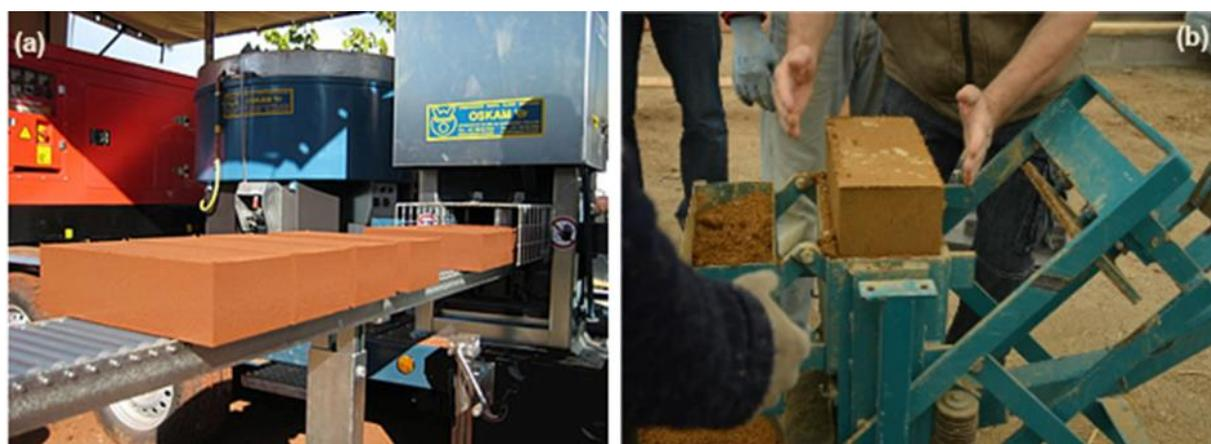
Figure III.11 - Image qui montre le compactage d'une brique l'aide de (a) machine hydraulique (b) presse manuelle.
