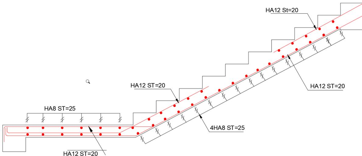
**Figure III.28.** Schéma de ferrailage de l'escalier d'entresol.
