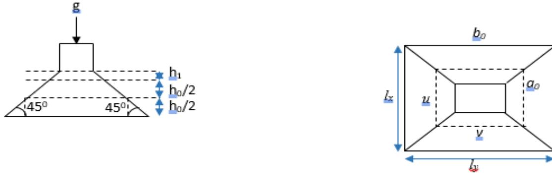
Figure II.27 Schéma représentant la surface d'impact.
