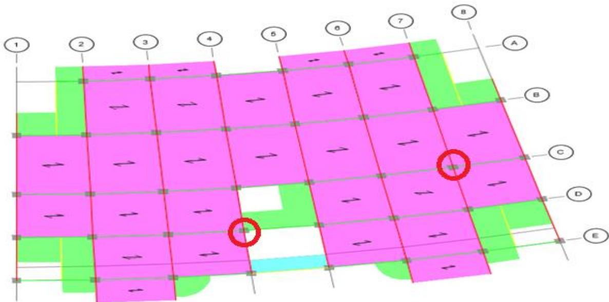
**Figure II.1.** Plan de disposition des poutrelles de RDC et l'étage courant
