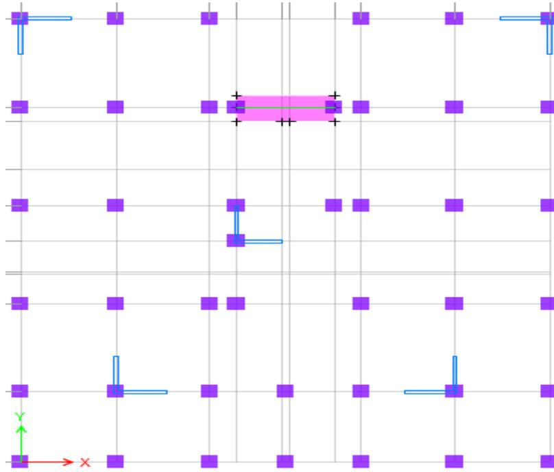
**Figure IV.2.** Disposition des voiles
